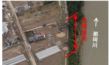
写真③堤防決壊状況(那珂川左岸40.0k)
